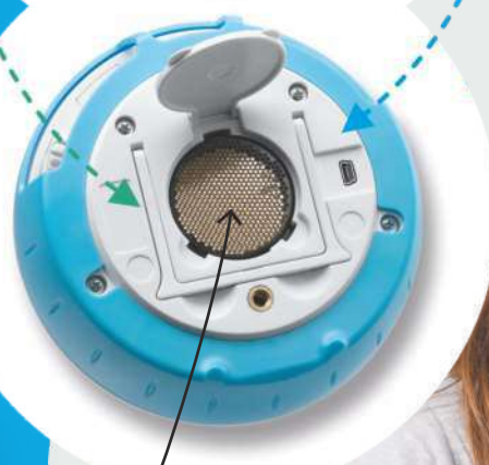
Czujnik odległości umieszczony z tyłu dysku
